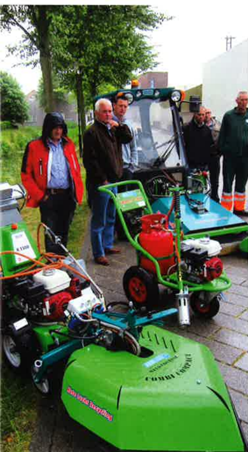
De machines die worden gebruikt, werken met hete lucht: de WeedTrac, de Air Trolley Pack en de Air Combi Compact.
