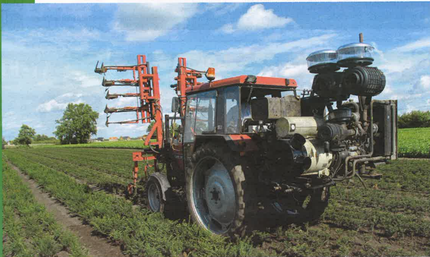
De noodzakelijke 7 bar luchtdruk komt van een compressor met eigen motor.
