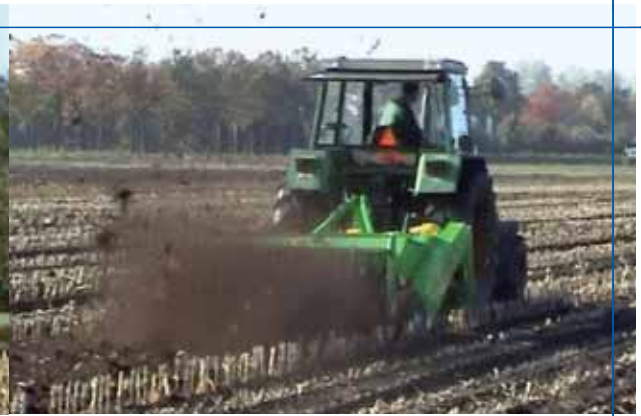
Demonstratie van de Kvik-up, een machine om wortelonkruiden als haagwinde en kweek mechanisch te bestrijden.
