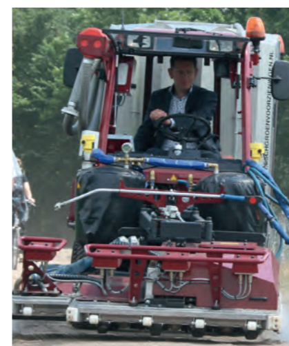
Wethouder Hoeksema bestuurt de WAVE. Een heetwatermachine voor onkruidbestrijding op verhardingen.
