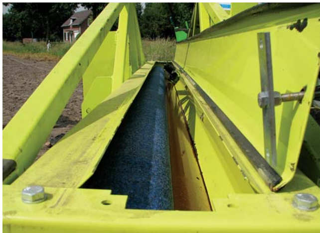
De blauwe rol bevat het middel dat door kleine gaatjes de rol doordrenkt, en geeft een dunne laag middel af aan de onderste rol.
