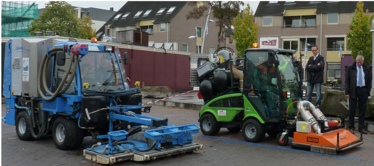
Niet-chemische methode: links de heetwatermachine en rechts de heteluchtmachine.
