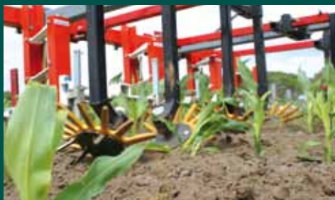
Dankzij de vingerwieders en de GPS-besturing is de maïs na het schoffelen nagenoeg geheel schoon.
